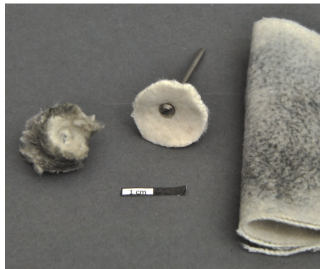
Abb. 10 Baumwollmolton und Baumwollmolton-Rondelle in Mandrel (Halterung für den Einsatz im Mikrobohrmotor)
