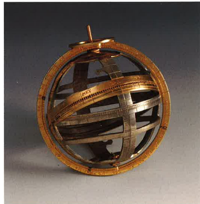
Abbildung 11. Die Armillarsphäre des Globuspokals. Man beachte den Ekliptikreif mit seinen Lochblenden (auch im Inneren) für den Gebrauch als Sonnenuhr sowie die beiden Diopter am Kolurreif zum Anvisieren des Sterns Capella.
